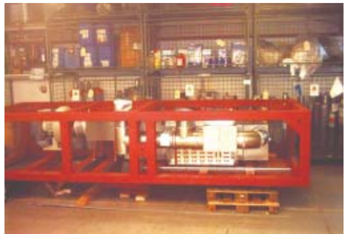
Prüfstandunterbau, kopfstehend (Foto: SP Hinsch)
